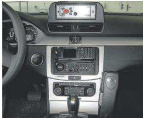
So sieht künftig der Innenraum eines Dienstwagens der Polizei aus. Oberhalb der Klimaanlage ist das Bedienteil für den Analogfunk, darüber das neu verbaut Bedienteil für den Digitalfunk zu sehen.
