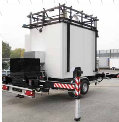
mBS mit ausgefahrenen Stützen. Der Anhänger nivelliert automatisch aus. The mBS supports, which extend automati- cally to level out the trailer.
