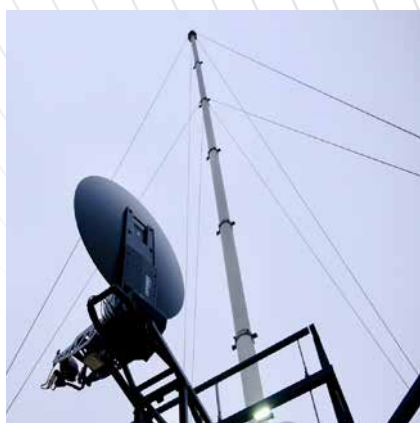
mBS mit ausgefahrenem Mast und Satellitenschüssel An mBS with mast and satellite dish deployed.
