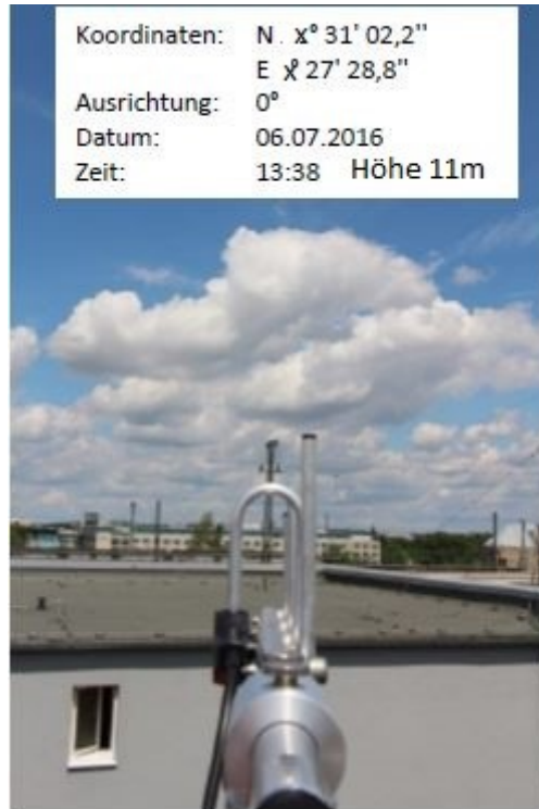
Abbildung 5: Dokumentation Antennen-Blickrichtung (Panoramamessung)
