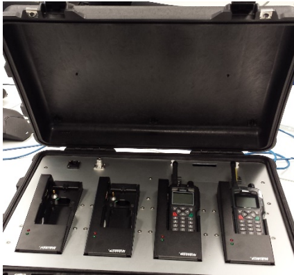
SEB Dokumentationsanlage im Kunststoffkoffer zur Aufzeichnung und Besprechung von bis zu vier Gesprächsgruppen mit Notebook für die Bedienung
