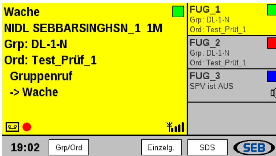
Eine Funklinie kann von mehreren FBP aus gleichzeitig aktiv geschaltet werden (Parallelbedienung). Diese Aktivierung wird bei den anderen FBP durch ein blaues LED-Feld in den entsprechenden Fenstern angezeigt. Wird von einem FBP aus gesendet, schalten die LED-Felder der Linie auf allen FBP auf grün um.
