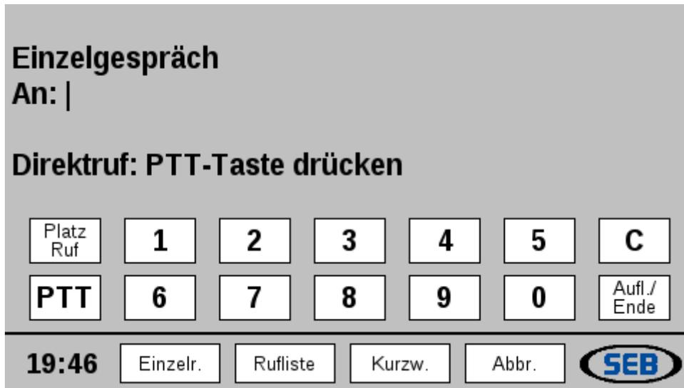
Mit den Tasten oder einer angeschlossenen USB-Tastatur kann die 7-stellige ISSI-Nummer des gewünschten Gesprächspartners eingegeben werden. Anschließend ist **die PTT-Taste, die Handapparat PTT oder die Fußtaste** zu betätigen.
