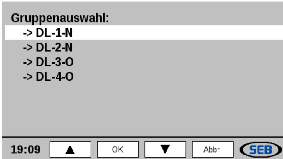
Mit Bestätigung durch „OK“ erscheint die Dialogfenster-Meldung „Gruppe wird gesetzt“. Nach dem erfolgreichen Setzen der neuen Gruppe wird automatisch das Gruppenauswahlmenü verlassen. Funktioniert die neue Gruppe nicht, z.B. weil sie am Standort nicht zur Verfügung steht, wird das Gruppenauswahlmenü auch verlassen und im Display erscheint „keine Gruppe / kein Ordner“.
