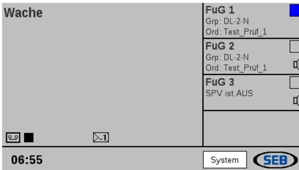
Die Zahl im Briefumschlag zeigt die Linie des Funkgerätes an, auf der die SDS eingegangen ist.
