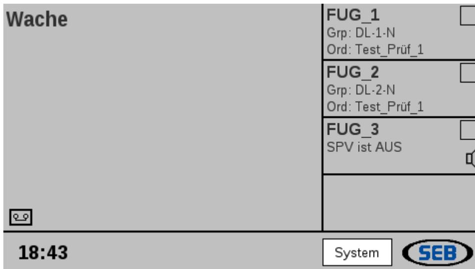
Abhängig von der – im Web-Interface - gewählten Konfiguration, zeigt die erste Zeile im rechten Teilfenster die „Alias-OPTA“ (nur bei digitalen Funkgeräten) oder einen - für das jeweilige Funkgerät - definierten Namen an.
