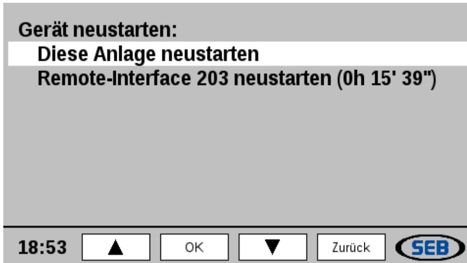
Die Zeitangabe (in Stunden[h]/Minuten[']/Sekunden["]) hinter den gelisteten Remote-Interfaces steht für die Zeit, die seit dem letzten Neustart des entsprechenden Gerätes vergangen ist.
