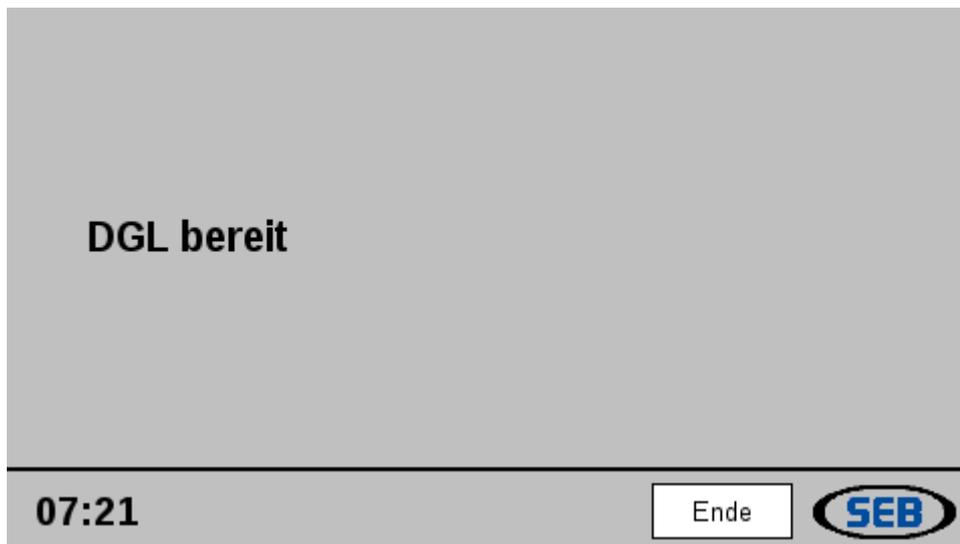
Mit Betätigung der PTT- Taste kann nun die Durchsage an alle bereiten Plätze – über die üblichen Besprechungsmöglichkeiten – erfolgen.
