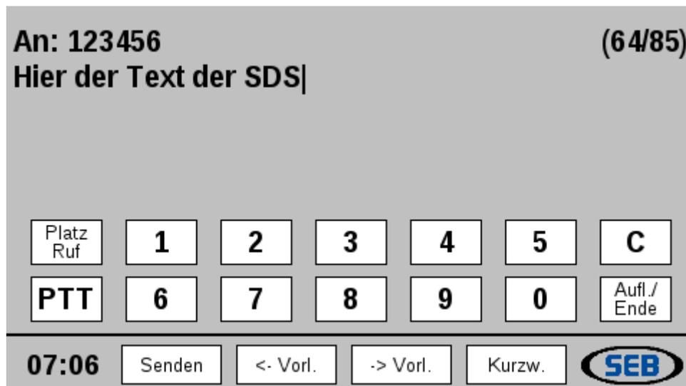
Mithilfe der USB-Tastatur kann nun der Text verfasst werden. Mit Betätigung der TAB- Taste ist die Eingabe der Empfänger ISSI über die USB-Tastatur möglich.
